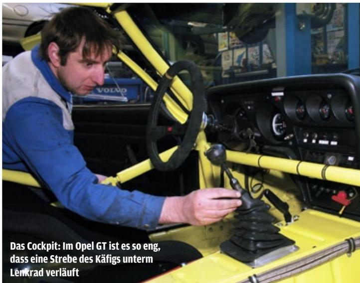
**Das Cockpit: Im Opel GT ist es so eng, dass eine Strebe des Käfigs unterm Lenkrad verläuft**
